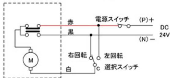
EARD-C型電動シリンダー 回路図 (DC24Vの場合)
