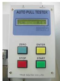
PC と接続してデータをエクセルに自動転送。破断までの荷重変化をグラフ化する事が出来ます。
