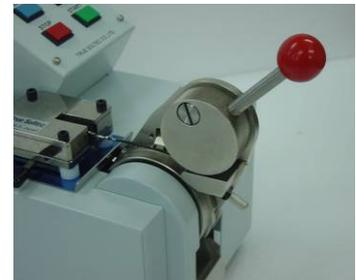
レバーを上げ、電線をクランプし止めに乗せレバーを離せばクランプ終了。
